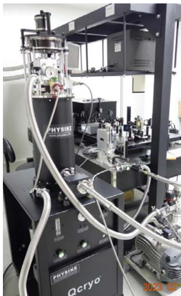
Qcryo-S-500 干式低温系统集成 BeCu DAC 压机、马达驱动旋转装置和螺杆调压装置，实现低温高压布里渊散射实验
