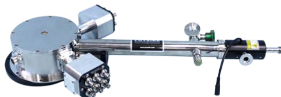
不锈钢真空罩，安装 12 个 BNC 真空电贯穿 12 根柔性同轴和 Puck 电学样品托
