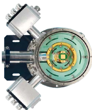
集成 12 个 BNC 真空贯穿和 puck 的 S-500 低温恒温器内部图片
