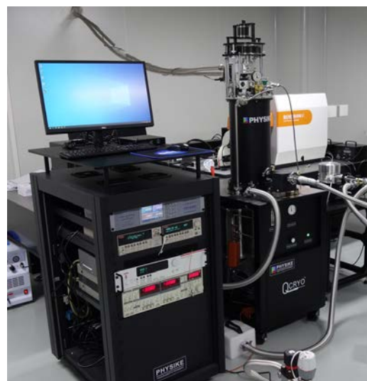
Qcryo-S-500 干式低温系统，内置双气膜调压机构和 BeCu 压机，匹配 RENISHAW 拉曼光谱仪，并集成电学测试功能
