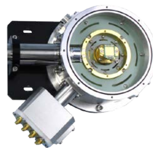
集成 12 个 SMA 真空贯穿和 puck 的 S-500 低温恒温器内部图片
