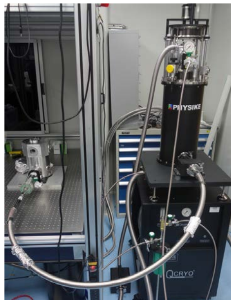
Qcryo-S-500 干式低温系统采用大腔体设计，容纳多组纳米定位台和物镜头，用于离子阱实验
